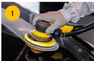
**Elimina defectos:** Utiliza Microstar® P1200 o bien una almohadilla de interfaz P1500 + 5 mm. Lija a velocidad media, entre 6000 y 7000 r.p.m.
