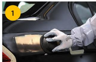
1 Aplica Mirka Dry Guide Coat (Revelador de Rayas) para que destaquen claramente las imperfecciones de la superficie.
