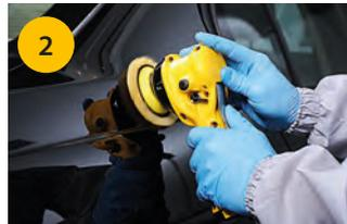
2 Presiona con suavidad sobre la máquina a una velocidad moderada, frota para limpiar bien y comprueba la superficie. Repite el proceso de aplicación del pulimento si es necesario.
