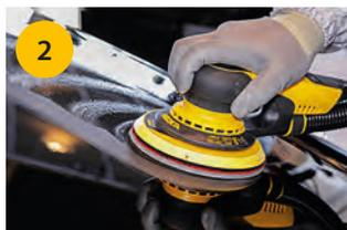
**Reduce los rayones:** Utiliza Abralon® 3000 para un lijado en húmedo. Lija a velocidad baja, unos 6000 r.p.m.
