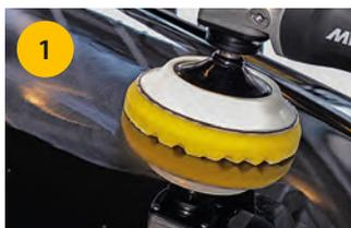
**Utiliza Polarshine® 10 y la esponja amarilla de waffle Mirka®.** Frota y haz la limpieza final con un trapo suave de microfibra de Mirka. Máxima velocidad de pulido: 1500 r.p.m.
