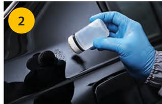
2 Utiliza siempre agua al lijar; aplica agua tanto en el abrasivo como en la zona defectuosa. Utiliza un dosificador de Mirka para obtener un mejor resultado.
