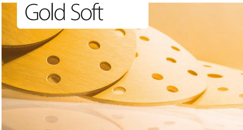
Gold Soft es un disco de lijado con un grosor óptimo de espuma. Este grano semiabierto ofrece una menor saturación de polvo y un mejor rendimiento en el corte. Su suave respaldo produce un excelente acabado para el pintado. Un borde más suave del disco elimina los daños en el lijado de perfiles. Gold Soft P500 es adecuado para aplicaciones de primer, mientras que P800 es adecuado para dar un tono mate a capas transparentes.
