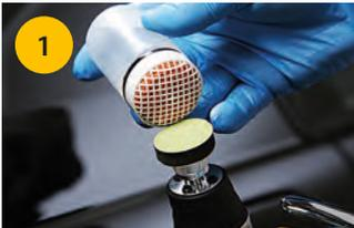
1 Para eliminar defectos, utiliza Polarstar® SR o WPF roseta o disco dependiendo del defecto y Mirka® AOS 130NV o bien la máquina Mirka® ROS 150NV.
