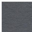
**Gris:** Fabricada con carburo de silicio en grano ultra fino. Por su composición remueve rebabas en plástico, mejores acabados en pintura, desgasta superficies de acrílico y da acabado en piezas de aluminio. Ideal para acabados, matizados y asentamiento de superficies.
